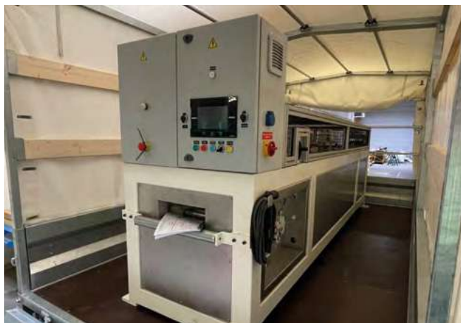
Une machine mobile pour le classement mécanique de peupliers. © Fibois Hauts-de-France.
